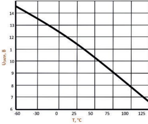
Зависимость напряжения запрета включения цепи детектора нуля  $U_{запр}$  от температуры
