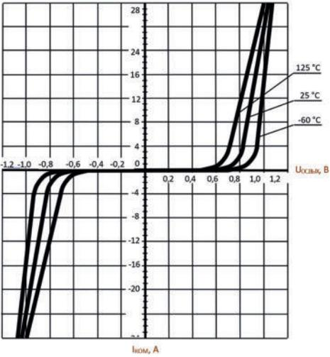
Зависимость выходного постоянного напряжения в открытом состоянии  $U_{ос.вых}$  от коммутируемого тока  $I_{ком}$  в диапазоне температур
