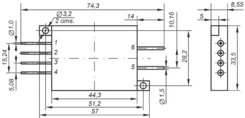
Корпус металлокерамический с теплоотводящим основанием.
