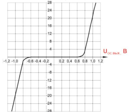
Типовая зависимость напряжения в открытом состоянии  $U_{ос.вых.}$  от коммутируемого тока  $I_{ком}$  при температуре корпуса  $(25 \pm 10) \text{ °C}$
