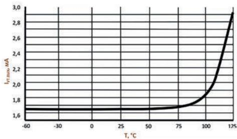
Зависимость тока утечки на выходе  $I_{UT,ВЫХ}$
