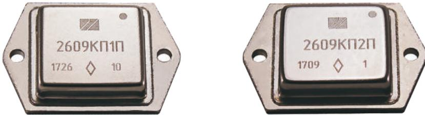
Микросборки изготовлены по гибридной технологии в соответствии с ОСТ В 11 1009, с оптоэлектронной гальванической развязкой, схемой управления и выходным каскадом на МОП – транзисторах.
