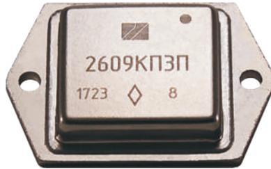
Микросборки изготовлены по гибридной технологии в соответствии с ОСТ В 11 1009, с оптоэлектронной гальванической развязкой, схемой управления и выходным каскадом на МОП-транзисторах.
