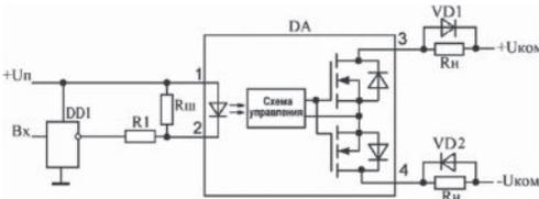
Коммутация однополярного напряжения
