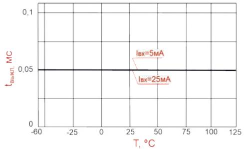
Типовая зависимость времени выключения  $t_{выкл}$  от температуры корпуса в диапазоне входного тока  $I_{вх}$
