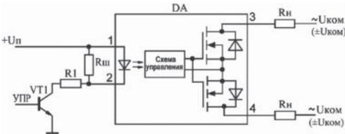
Коммутация двухполярного и переменного напряжения
