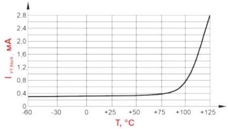
Типовая зависимость тока утечки на выходе  $I_{ут.вых}$  от температуры корпуса при постоянном напряжении коммутации  $U_{ком} = 600 \text{ В}$
