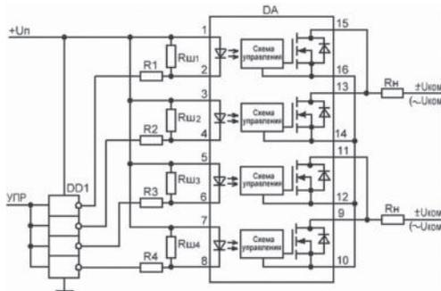
Параллельно- последовательное включение – коммутация двухполярного и переменного напряжения, увеличение коммутируемого тока в два раза.
