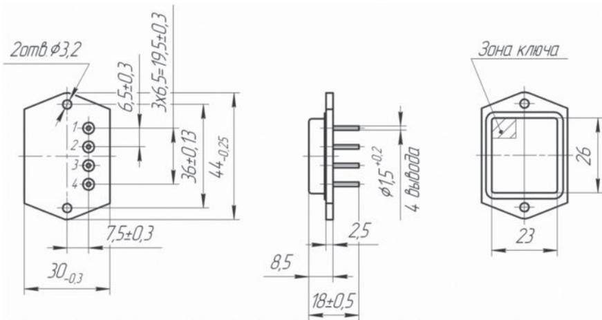
Корпус типа КТ-104-1.01Н, металлостеклянной с теплоотводящим основанием.
