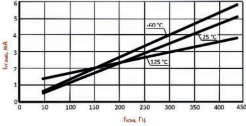
Зависимость тока утечки на выходе  $I_{ут.вых}$  от частоты коммутируемого напряжения  $f_{ком}$  при напряжении коммутации  $U_{ком} = 250$  В в диапазоне температур корпуса
