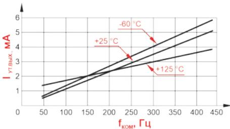
Типовая зависимость тока утечки на выходе  $I_{ут.вых.}$  от частоты коммутации  $f_{ком}$  при напряжении коммутации  $U_{ком} = 250 \text{ В}$  в диапазоне температур корпуса
