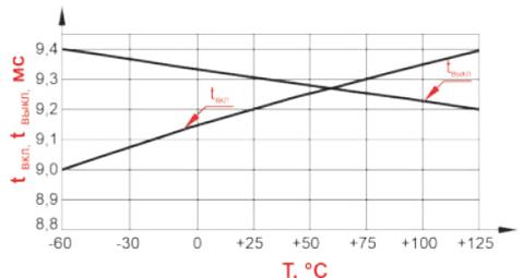
Типовая зависимость времени включения  $t_{вкл.}$  и времени выключения  $t_{выкл.}$  от температуры корпуса при  $U_{ком} = 250 \text{ В}$ ,  $I_{ком} = 5 \text{ А}$ ,  $f_{ком} = 50 \text{ Гц}$ .
