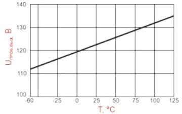
Типовая зависимость напряжения пробоя  $U_{проб.вых}$  от температуры окружающей среды при  $I_{проб.вых} = 10 \text{ мкА}$
