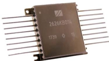
Микросборки изготовлены в соответствии с ОСТ В 11 1009 по гибридной технологии, с оптоэлектронной гальванической развязкой, схемой управления и выходным каскадом на МОП-транзисторах.
