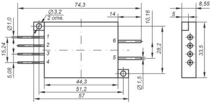
Корпус металлоглазый с теплоотводящим основанием.
