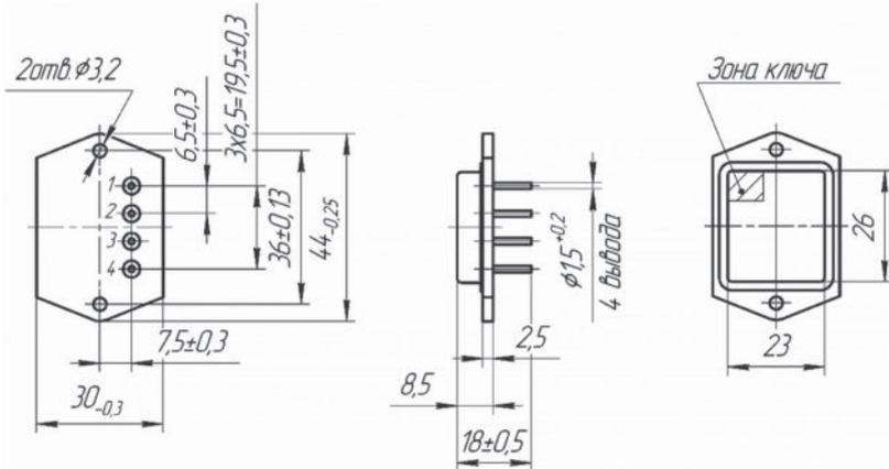
Корпус типа КТ-104.1 01 Н, металлокерамический с теплоотводящим основанием.
