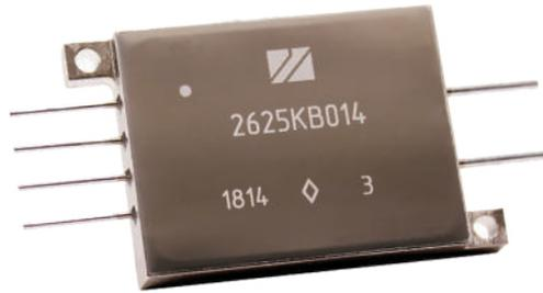
Микросборки изготовлены с ОСТ В 11 1009 по гибридной технологии, с опто-электронной гальванической развязкой, схемой управления с контролем перехода фазы коммутируемого напряжения через «ноль» и выходным каскадом на тиристорах с RC – цепью ограничения напряжения при переходных процессах.
