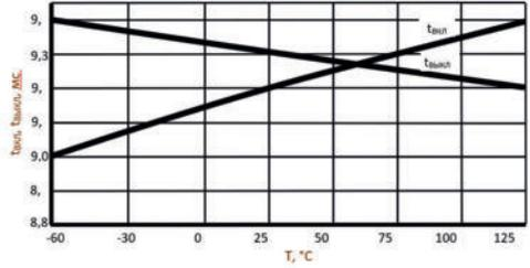
Зависимость времени включения  $t_{вкл}$  и ремени выключения  $t_{выкл}$
